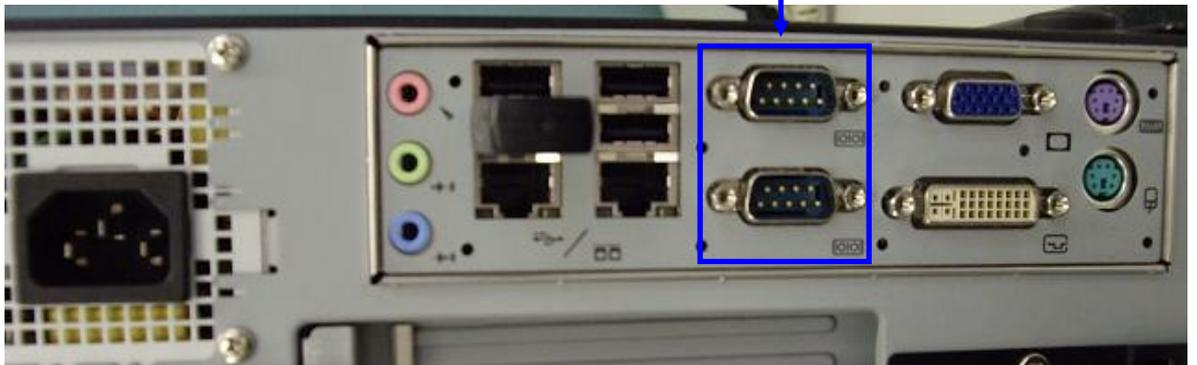
※インターフェースアダプタ(DS-203,USB232-00)を接続する場合、シリアルケーブルの D-Sub9Pin コネクタをインターフェースアダプタに接続します。
