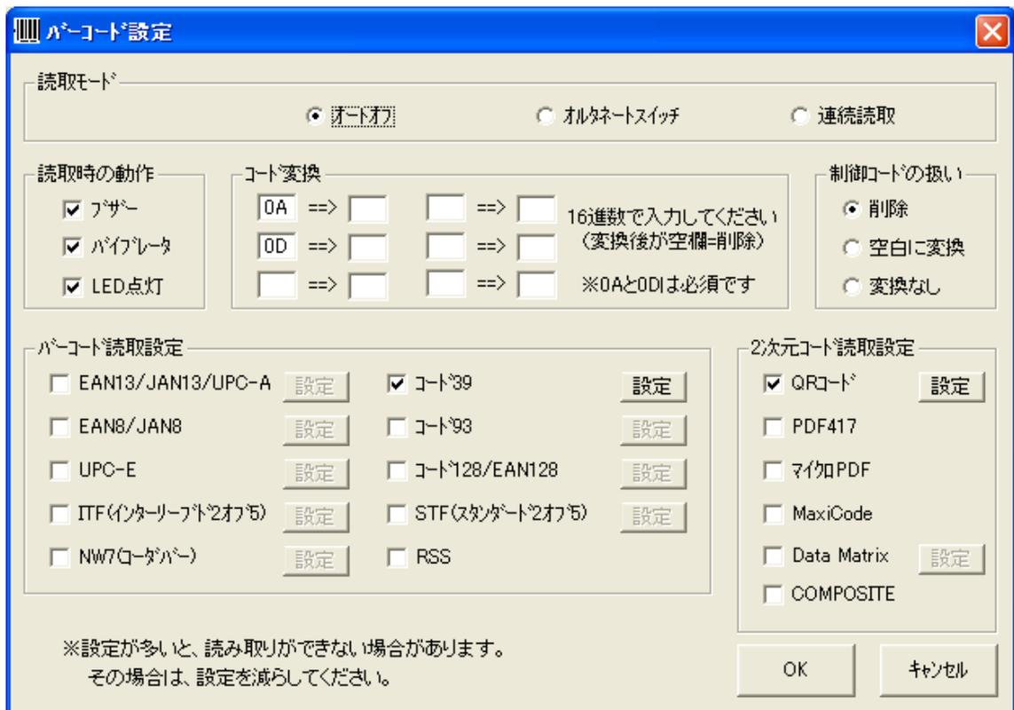
上記は、BHT500\_MENU の設定-バーコード設定で表示されるダイアログです。BHT500\_MENU を用いることで、読み込み可能バーコードや読取モードを変更できます。
